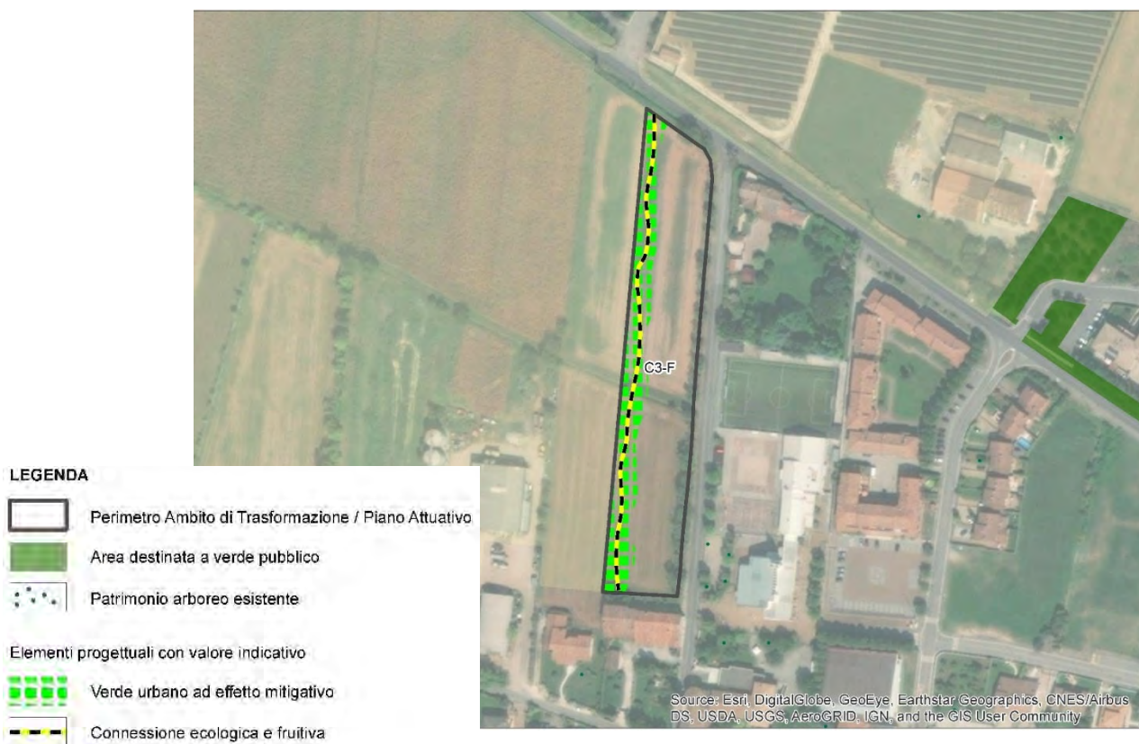
Esempio di fascia di mitigazione
