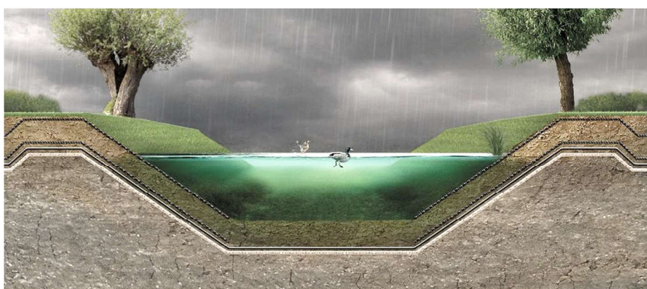
Figura 3. Bacino di espansione
