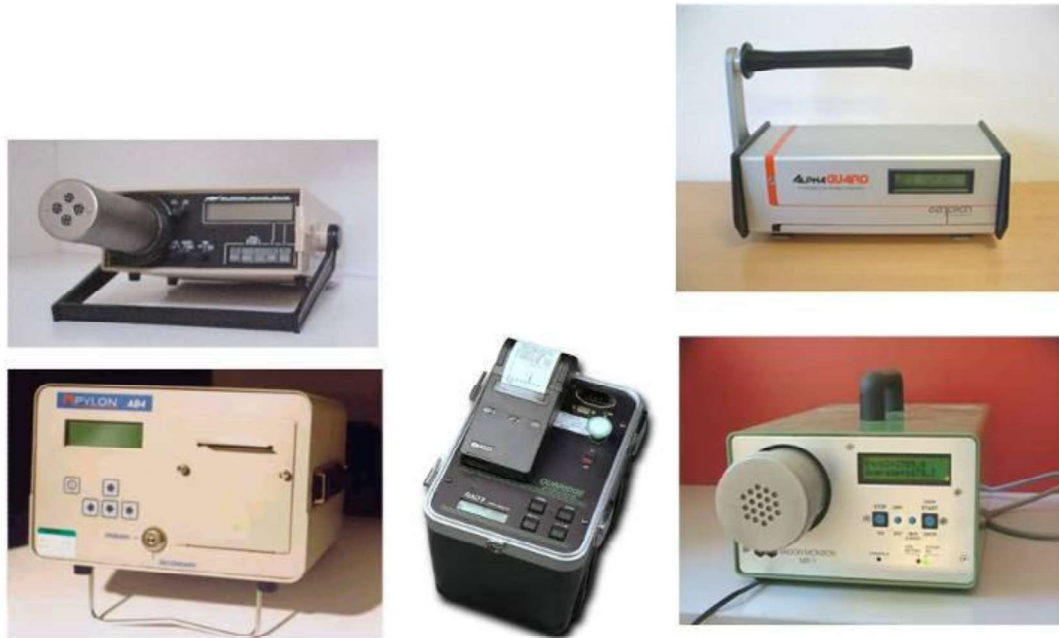
Figura 36: Alcuni strumenti di misurazione attiva della concentrazione di radon
