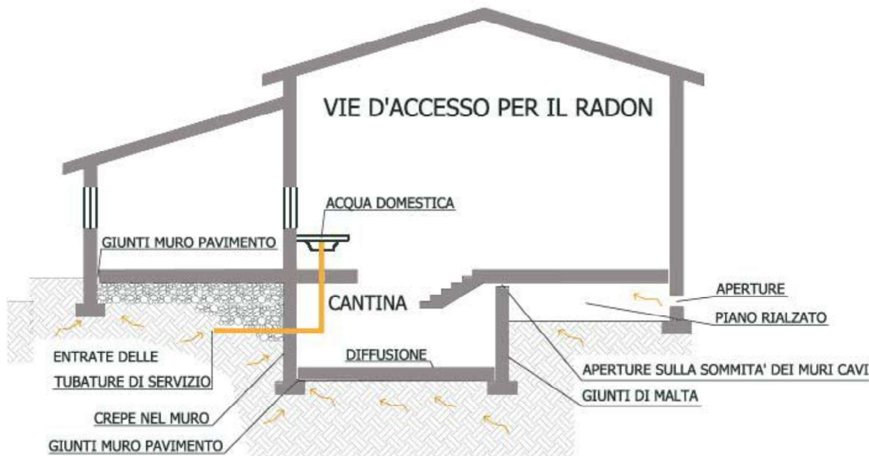
Figura 5: vie d'accesso per il radon
