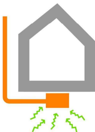
Figura 13: depressione del sottosuolo tramite pozzetto.
