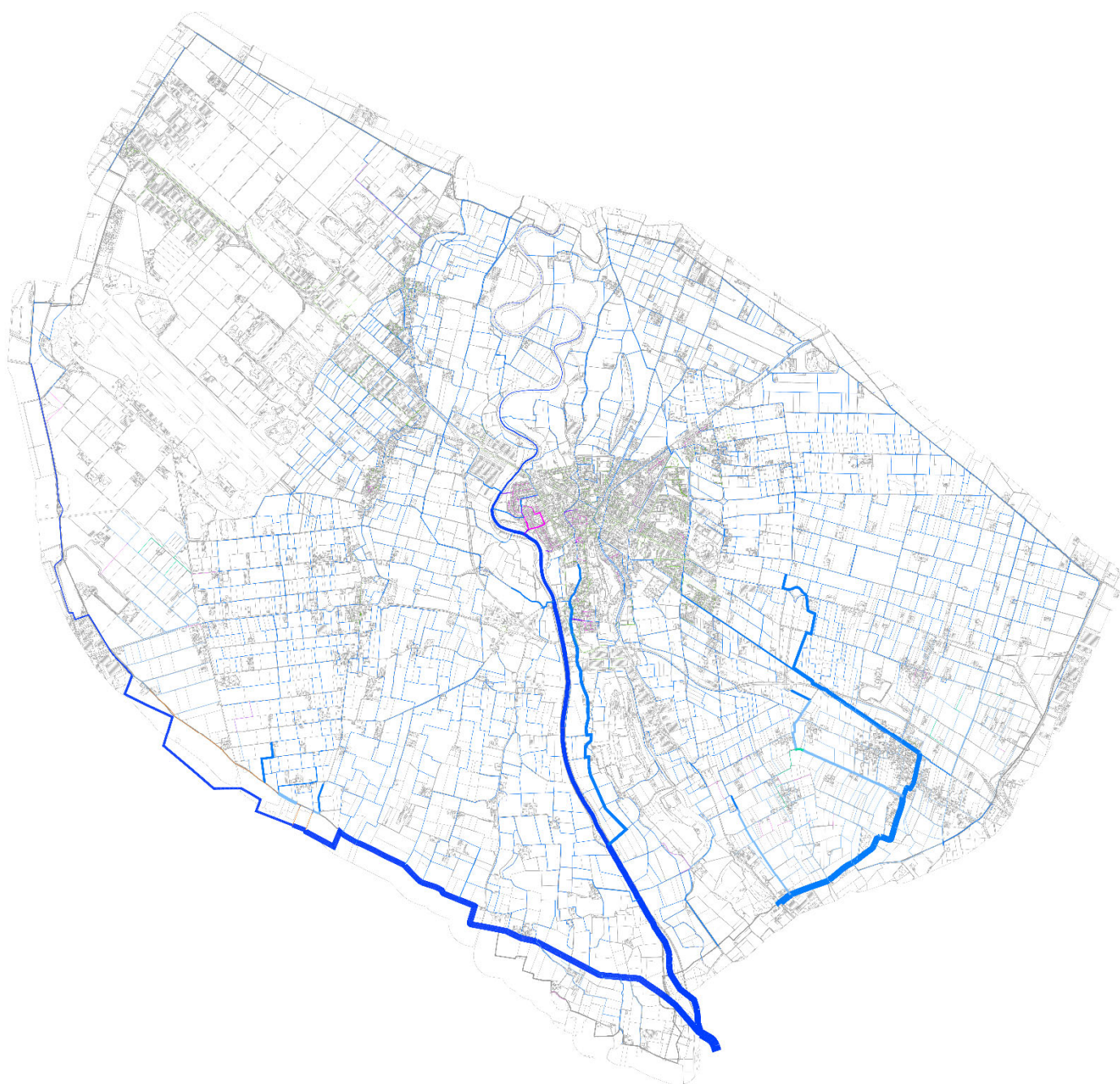
Schema idraulico di riferimento con spessori proporzionali alle portate di colmo
