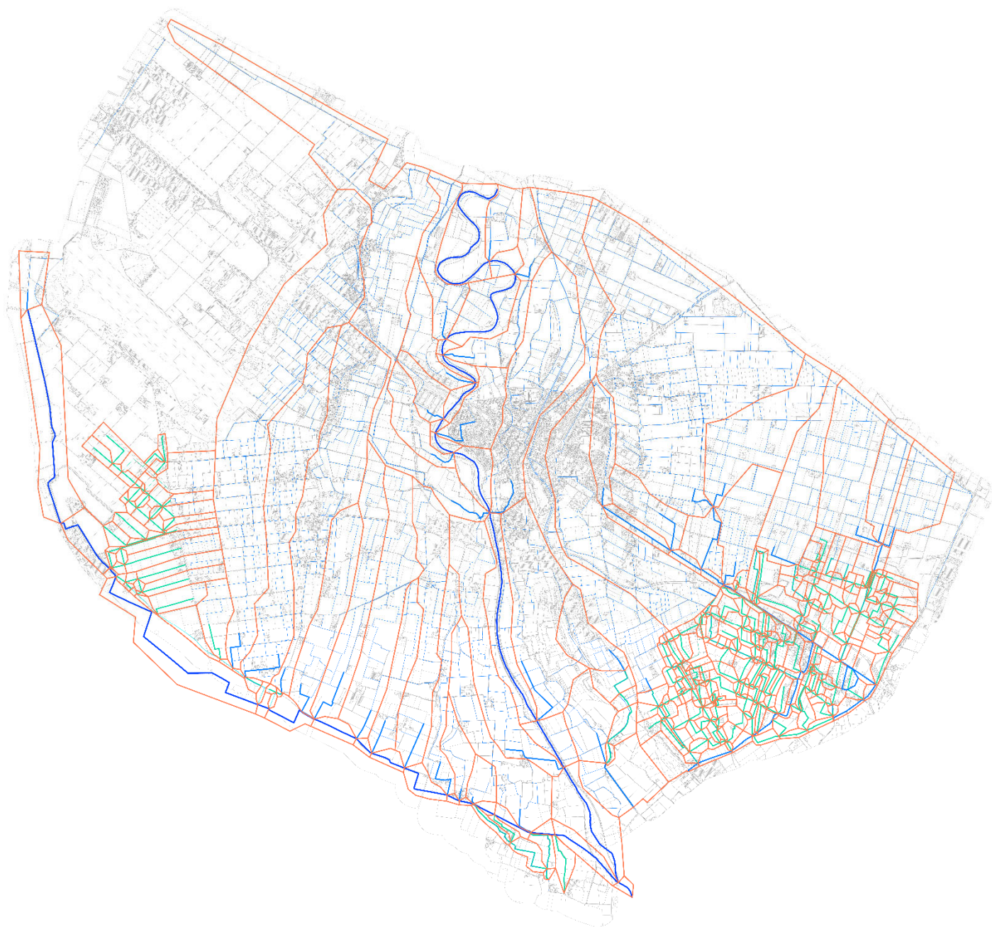
Rete di calcolo delle portate affluenti al reticolo idrico con bacini idrografici
