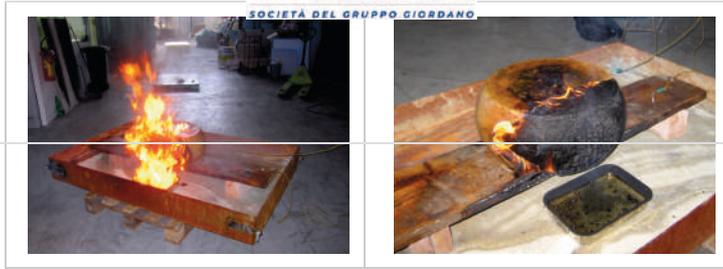
**Risultato:** all'esaurimento dei 500 ml di benzina (circa 4 minuti e 15 secondi), il campione ha proseguito la combustione e dopo 15 minuti dall'inizio della prova è dovuto intervenire un operatore per spegnere il fuoco.
