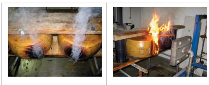
**Risultato:** l'esposizione alla radiazione di circa 12 kW/m<sup>2</sup> (sullo scalzo delle forme, nel punto più vicino al pannello vi era un flusso termico pari a 16,7 kW/m<sup>2</sup>), per 30 minuti, ha provocato un'emissione di fumi e gas di pirolisi senza alcuna combustione. I gas di pirolisi si sono incendiati solo quando è stata applicata una fiamma libera innescando la combustione appunto. Trascorsi circa 2 minuti, il fuoco è stato estinto con l'intervento di un operatore.
