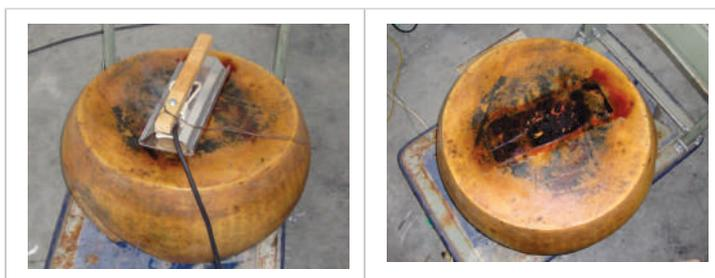
**Risultato:** la Termo-resistenza elettrica, una volta raggiunta la temperatura di 350 °C, ha provocato l'emissione di gas, fumi e scioglimento della materia grassa che era a contatto con la piastra di alluminio senza alcun effetto di carbonizzazione ne tantomeno di combustione.
